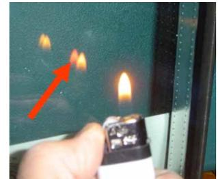
Der Feuerzeug-Test zeigt, ob Isolier- oder Wärmeschutzglas eingebaut wurde.
