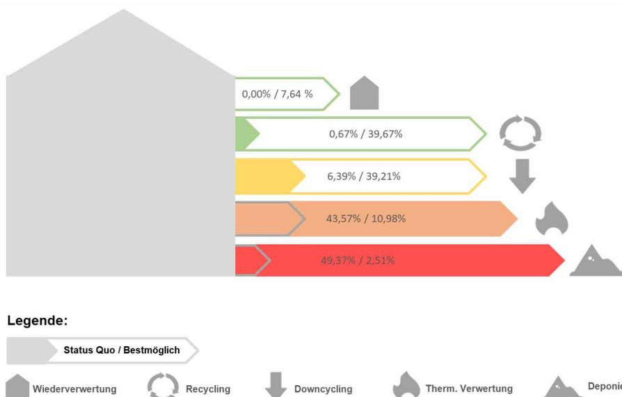
**Abbildung 4:** Auswertung des Forschungsprojekts „Rural Mining“ - Analyse des Rückbaus in der Praxis/Zerlegung von Bauteilen. Quelle: Essig, N., Kustermann, A., Lindner, S. und K. Kegler, 2020
